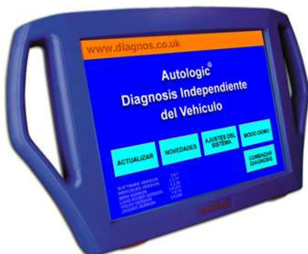
Sistema de diagnosis Autologic® - Pantalla principal
